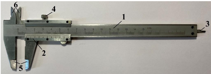
Рис. 3. 1 – штанга з поділками ціною 1 мм, 2 – рамка, рухома частина зі шкалою ноніуса з ціною поділки 0,02 мм та 3 – нутрометром, 4 – затискний гвинт, 5 – вимірювальні ніжки зовнішніх габаритів, 6 – вимірювальні ніжки внутрішніх габаритів.
